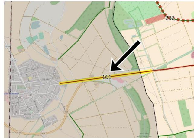
IST-Zustand: Der vorhandene Geh- und Radweg endet und wird als schmaler Gehweg mit Freigabe für den Radverkehr weitergeführt. Die zulässige Höchstgeschwindigkeit liegt bei 100 km/h. Geeignete Alternativverbindungen über Wirtschaftswege fehlen.
