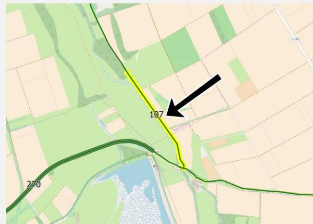
IST-Zustand: Der asphaltierte Weg endet. Der betrachtete Abschnitt verfügt über eine wassergebundene Decke mit Bewuchs und losem Untergrund.
