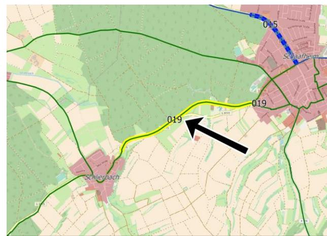
IST-Zustand: Der Weg nördlich der Landesstraße befindet sich in einem schlechten Ausbauzustand und ist deshalb nur eingeschränkt mit dem Fahrrad zu befahren. Durch die Linienführung, die teilweise abseits der Straße verläuft, ist die soziale Sicherheit nicht gewährleistet.
