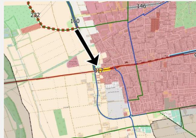
IST-Zustand: Der befestigte Radweg endet am Ortseingang. Es fehlt eine sichere Radverkehrsführung im weiteren Verlauf. Die Querungssituation ist mangelhaft.
