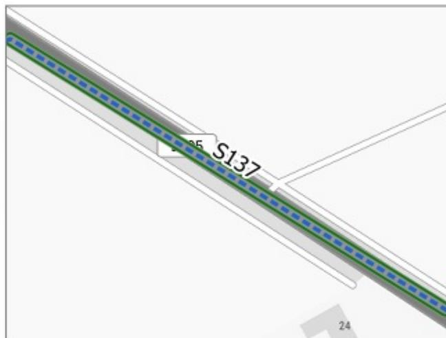
**Situation:** Es existiert kein straßenbegleitender Geh- und Radweg. Der Radverkehr wird auf der Fahrbahn geführt. Die zulässige Höchstgeschwindigkeit beträgt 100 km/h. Es gibt eine Alternativverbindung über abseits der L 405 verlaufende, jedoch schadhafte Wirtschaftswege.
