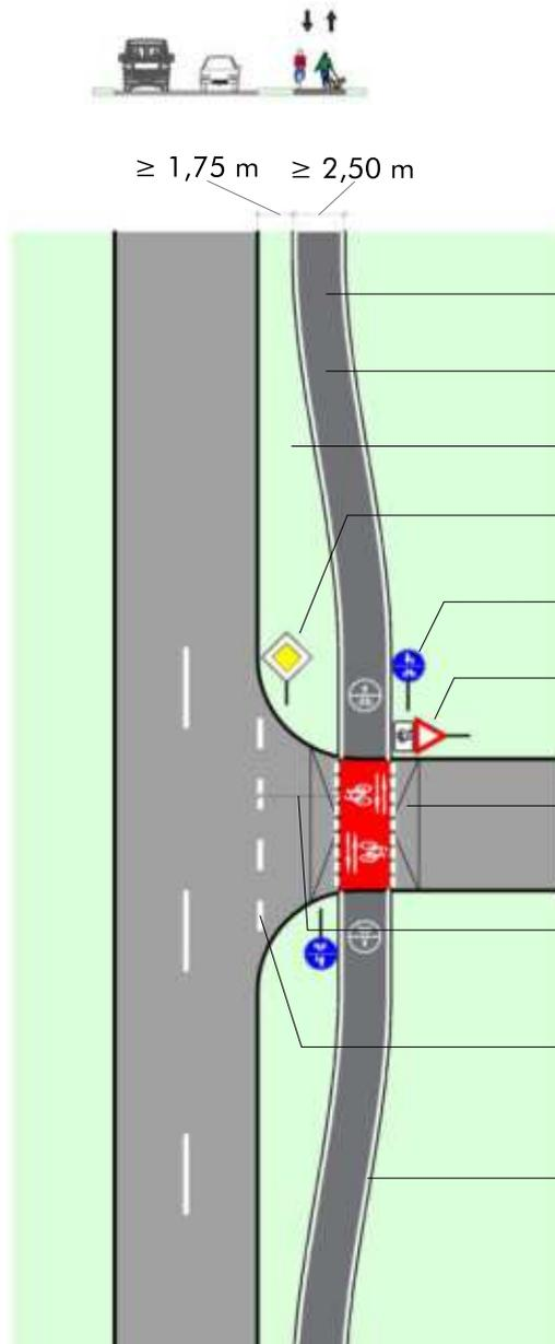
Die schematische Musterlösung zeigt den Grundsatz, dass der Radverkehr im Zuge bevorrechtigter Straßen ebenfalls mit Vorrang geführt wird. Bei der konkreten Ausgestaltung sind die Leistungsfähigkeit und die Verkehrssicherheit sicherzustellen und im Rahmen der Planung nachzuweisen. Ist eine Bevorrechtigung des Radverkehrs nicht möglich, sind Alternativen wie Signalisierung oder planfreie Querungen zu prüfen. Weitere Hinweise unter [www.schneller-radfahren.de](http://www.schneller-radfahren.de)
