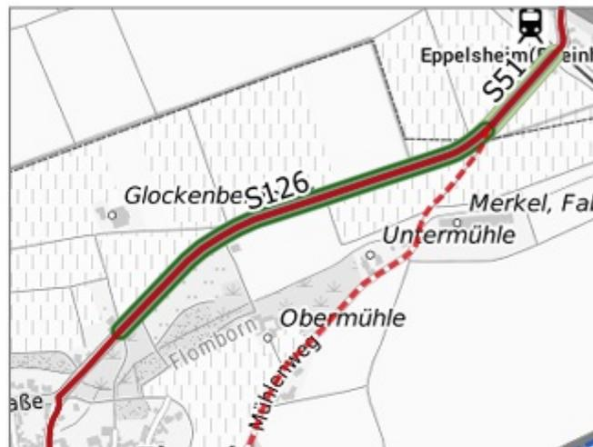
**Situation:** Es existiert kein straßenbegleitender Geh- und Radweg. Der Radverkehr wird auf der Fahrbahn geführt. Die zulässige Höchstgeschwindigkeit liegt bei 100 km/h. Derzeit können Radfahrende die Verbindung über den Mühlenweg nutzen.
