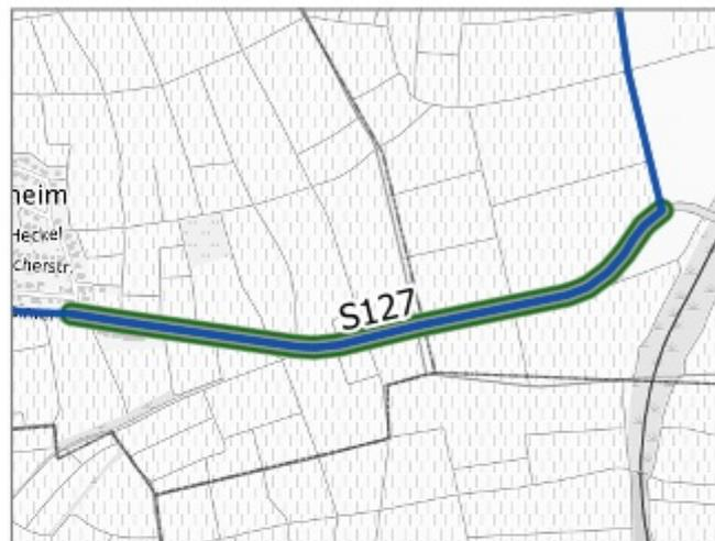
Situation: **Es existiert kein straßenbegleitender Geh- und Radweg. Der Radverkehr wird auf der Fahrbahn geführt. Die zulässige Höchstgeschwindigkeit liegt bei 100 km/h.**
