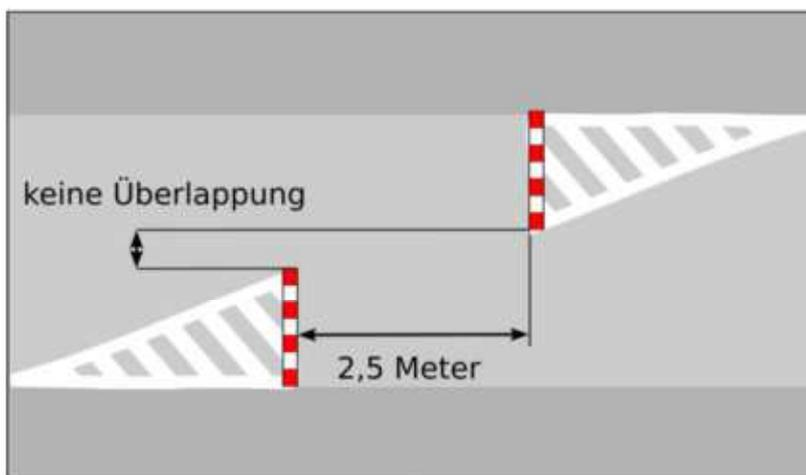
Abbildung 2: Empfohlene Anordnung von Umlaufsperrren - Einsatz von Umlaufsperrren nur bei besonderer Gefahrenlage
