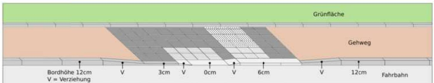
Abbildung 2: Querungsstelle mit verschiedenen Bordhöhen und Bodenindikatoren
