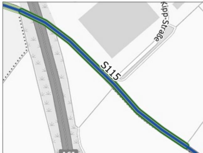
Situation: Es existiert kein straßenbegleitender Geh- und Radweg. Der Radverkehr wird auf der Fahrbahn geführt. Die zulässige Höchstgeschwindigkeit liegt bei 50 km/h. Sehr hohe Verkehrsbelastung. Es gibt keine geeignete Alternativverbindung.
