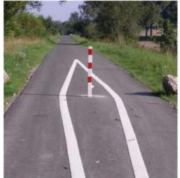
Abbildung 1: Warnmarkierung eines Sperrpfostens
