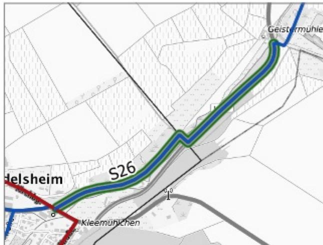
**Situation:** Es existiert kein straßenbegleitender Geh- und Radweg. Der Radverkehr wird auf der Fahrbahn geführt. Die zulässige Höchstgeschwindigkeit liegt (abschnittsweise) bei 70 km/h. Es gibt keine geeignete Alternativverbindung. Laufende Planungen zum Neubau eines straßenbegleitenden Radweges.
