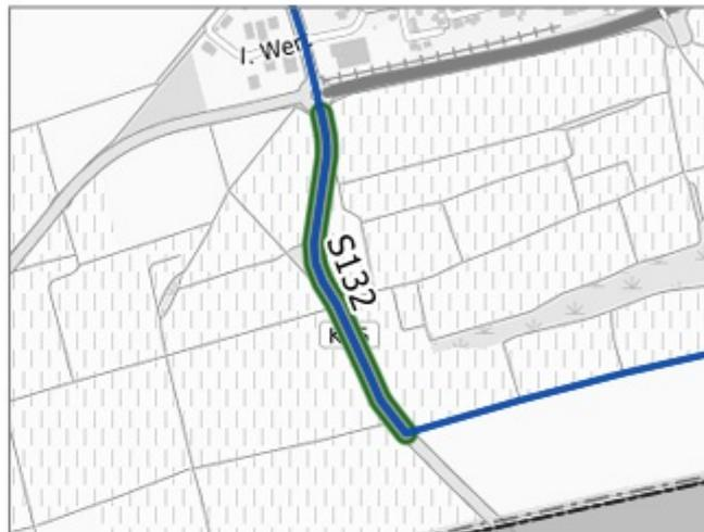
Situation: Es existiert kein straßenbegleitender Geh- und Radweg. Der Radverkehr wird auf der Fahrbahn geführt. Die zulässige Höchstgeschwindigkeit liegt bei 100 km/h. Es gibt keine geeignete Alternativverbindung.
