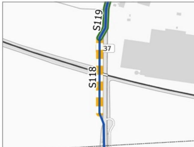
Situation: Keine sichere Querung der Bahntrasse möglich. Der straßenbegleitende Radweg endet ohne geregelten Übergang auf die Fahrbahn. Der Radverkehr wird über die K 37 im Mischverkehr geführt (Engstelle)
