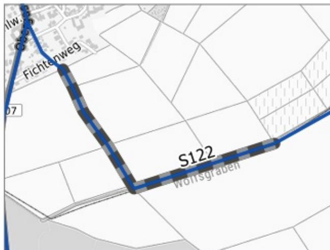
Situation: Der betrachtete Abschnitt verfügt über eine schadhafte wassergebundene Decke (mit teilweise grobem Schotter) bzw. schadhafte Betonplatten. Derzeit können Radfahrende die parallel verlaufende L 405 nutzen, die jedoch über keine Radverkehrsanlagen verfügt.
