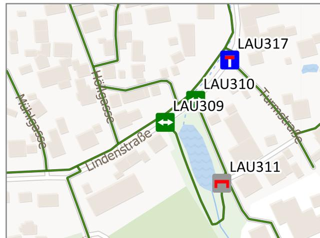
**Situation:** Es existiert keine direkte Querungsmöglichkeit zwischen dem Erschließungsweg zur Parkanlage und dem straßenbegleitenden Gehweg an der Lindenstraße. Die Sichtbeziehung zwischen querendem Fußverkehr und dem Kfz-Verkehr sind durch die Begrünung eingeschränkt.
