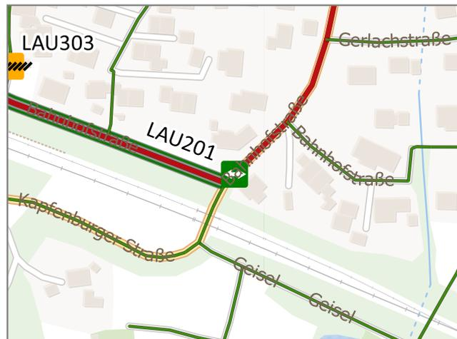
**Situation:** Es existiert keine Querungshilfe. Das Kfz-Verkehrsaufkommen beträgt 4337 Kfz/24h. Aufgrund der Kurve und der Bahnunterführung sind die Sichtverhältnisse eingeschränkt.
