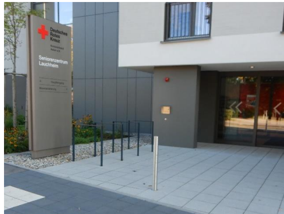
Abbildung 13: Anlehnbügel am Haupteingang des Seniorenzentrums
